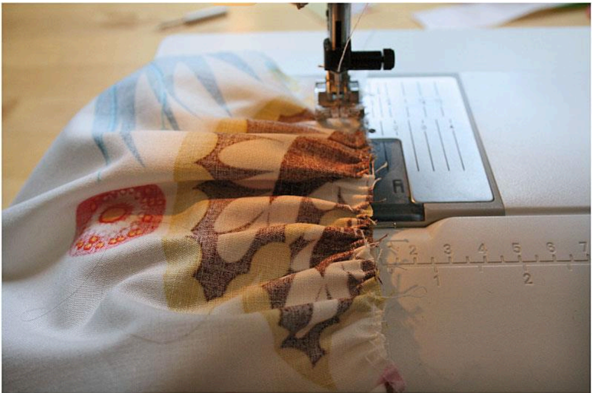
Abbildung 21 Kräuseln - Jetzt nähst Du sie mit 1 cm Nahtzugabe zusammen. Die Kräuselung liegt dabei oben. Immer mal wieder das Teil zurechtzupfen, damit die kleinen Fältchen schön liegen.
